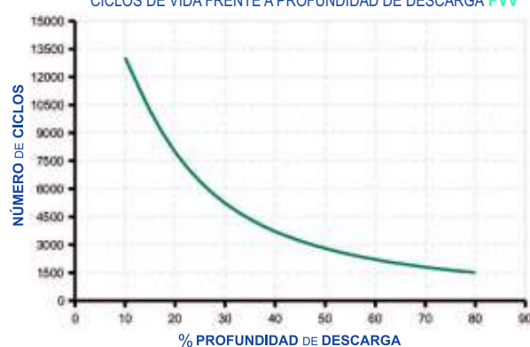
CICLOS DE VIDA FRENTE A PROFUNDIDAD DE DESCARGA PVV
